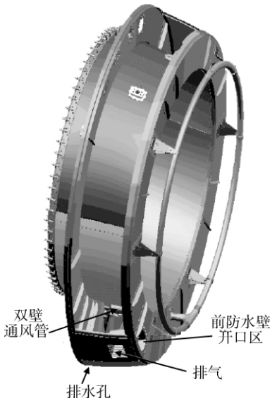
图 3 空气入口和出口位置 Fig. 3 Positions of air inlet and exit
